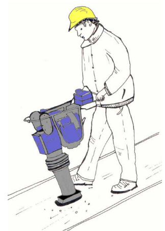
5.5.4 rechts unten Verdichten mit dem Rüttelstampfer
