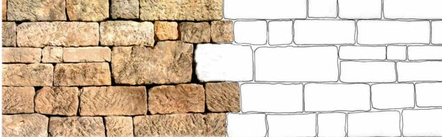
e Unregelmäßiges Schichtenmauerwerk
