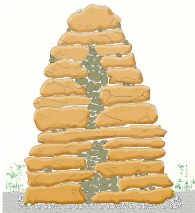
6.2.3 Zweiwandiges Mauerwerk (Schemazeichnung), siehe auch Seite 13
