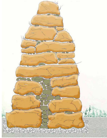
2.2.3 links Zweiwandiges Mauerwerk
